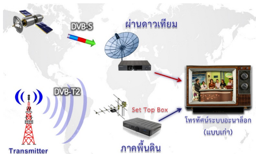
รูปที่ 1.2 เปรียบเทียบการส่งสัญญาณระบบแพร่ภาพดิจิทัลผ่านดาวเทียม (DVB-S) กับ ระบบแพร่ภาพดิจิทัลภาคพื้นดิน (DVB-T)
