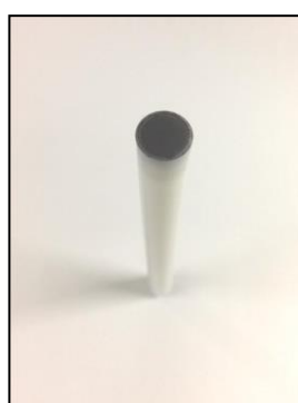
รูปที่ ก-1.4 ขั้วไฟฟ้าคาร์บอนเพส
