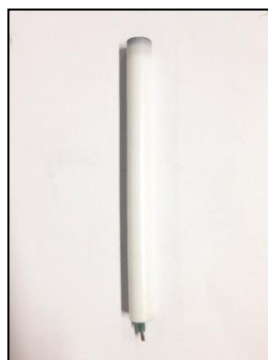
รูปที่ ก-1.2 การประกอบขั้วไฟฟ้า
