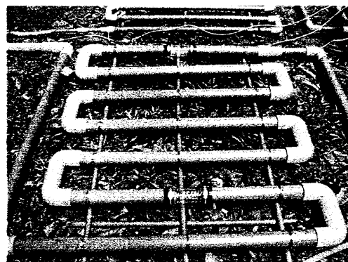
ภาพที่ ง-6 การติดตั้งท่อใสเพื่อใช้สังเกตการไหล และการก่อตัวของ Floc ภายในท่อ
