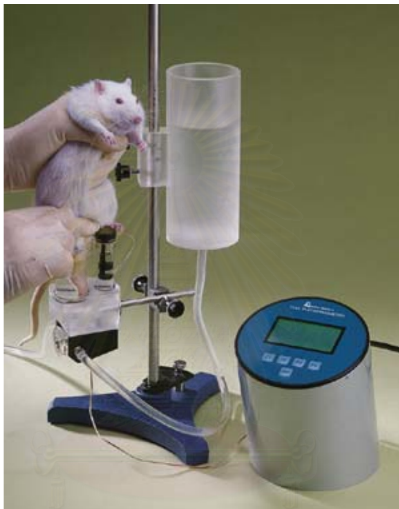
ภาพที่ 13 แสดงเครื่องมือ plethysmometer ที่ใช้ในการทดลองฤทธิ์การยับยั้งการบวมของ อุ้งเท้าหนูที่กระตุ้นด้วย 1% carrageenan
