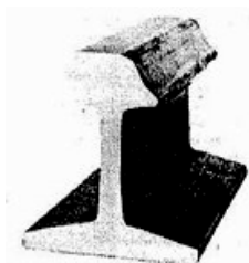
รูปที่ 4.25 การสึกที่ด้านข้างของราง (กิจการร่วมค้า ซีเคเอสแอล, 2545)
