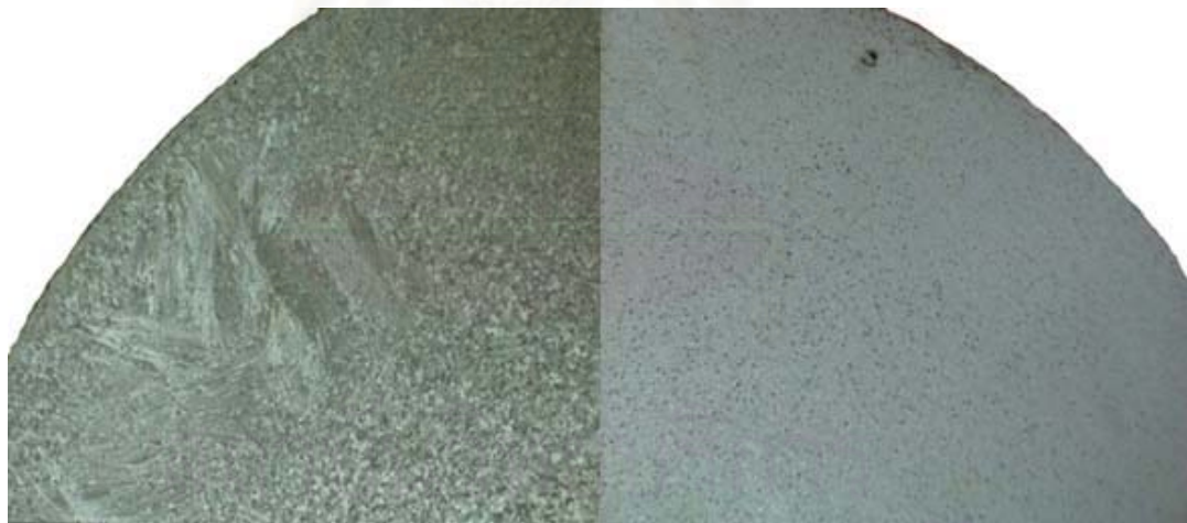
ภาพที่ 4.1 ผลเปรียบเทียบโครงสร้างมหภาคของDC(ซ้าย), LFEC(ขวา)
