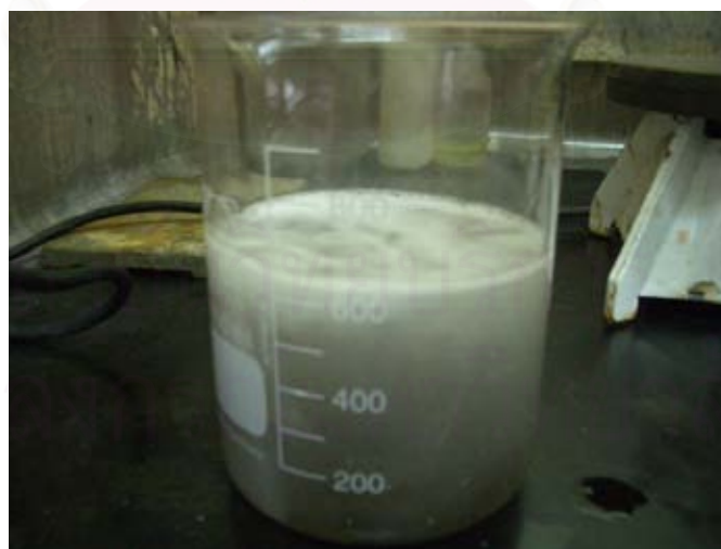
ภาพที่3.2 การทำปฏิกิริยาของชิ้นงาน ( \text{Al} - 9.8\text{Zn} - 2.5\text{Mg} - 2.3\text{Cu} ) กับกรดไฮโดรอกไซด์ผสมกับน้ำกลั่นกัดผิวหน้าเพื่อดูโครงสร้างมหภาคที่อุณหภูมิ 60 – 70 องศาเซลเซียส
