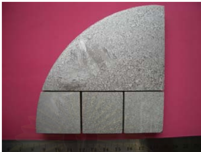
ภาพที่ 3.3 การตัดแบ่งชิ้นงานจากกลางไปถึงผิวชิ้นงาน (จากขวามาซ้ายตามลำดับ)
