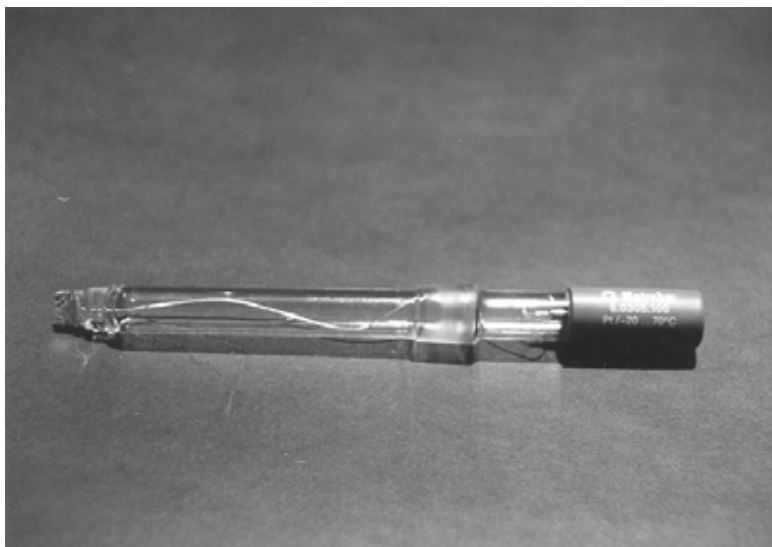
รูปที่ 3.5 อิเล็กโทรดวัดกระแส (Counter electrode)
