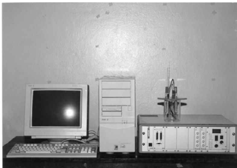
รูปที่ 3.3 เครื่องโพเทนชิโอสแตทรุ่น PGSTAT 20(GPES)
