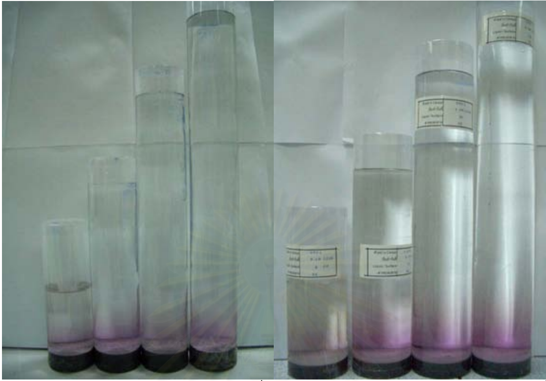
รูปที่ 4.37 การสะสมความเข้มข้นของ Mn ที่บริเวณการทดสอบการชะละลายของตัวอย่างวันที่ (ซ้าย) 22 ตุลาคม 2547 และ (ขวา) 7 กุมภาพันธ์ 2548
