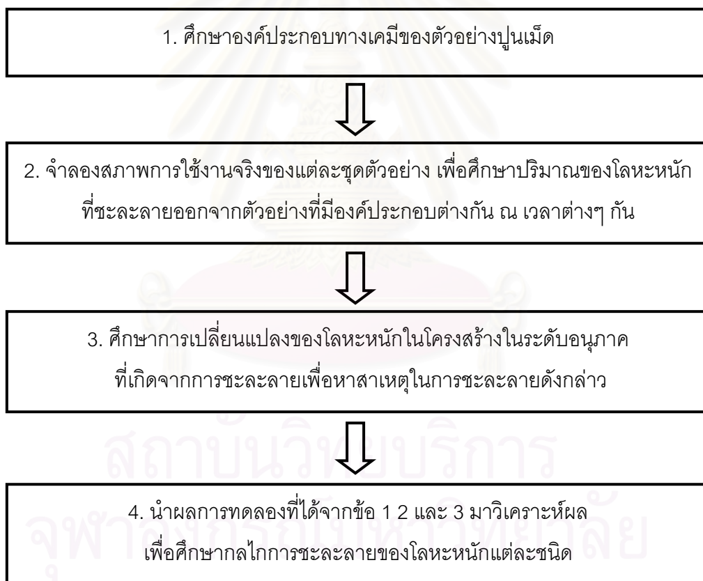
รูปที่ 3.2 แผนผังการทดสอบการชะละลายโดยรวม
