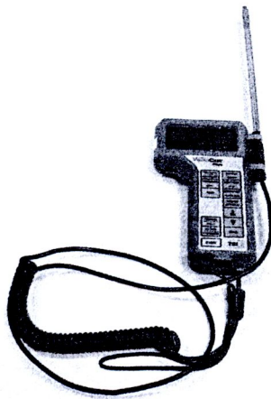
รูป ก.4 อุปกรณ์วัดความเร็วลมและความดัน ยี่ห้อ TSI รุ่น 8385-M-GB
