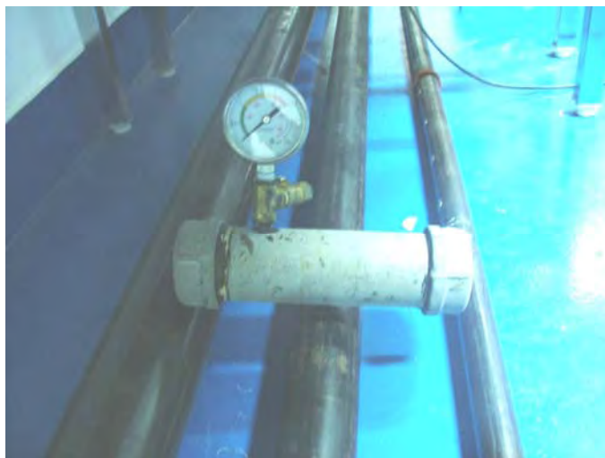
รูปที่ 3.13 Chamber วัดอัตราการรั่วของท่อทั้ง 3 ขนาดที่ใช้ในงานวิจัย
