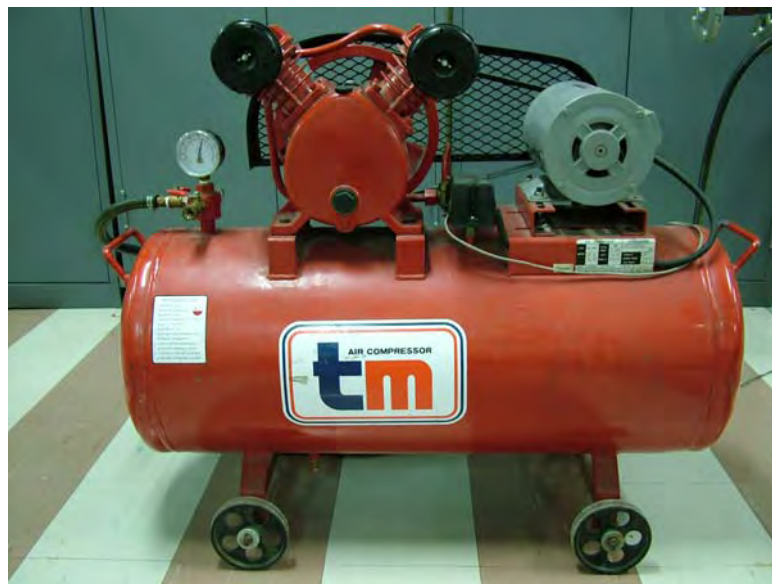
รูปที่ 3.2 เครื่องอัดอากาศที่ใช้ในงานวิจัย
