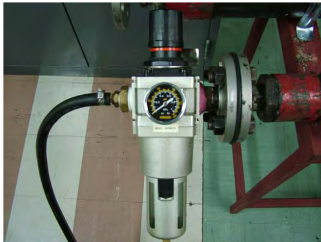
รูปที่ 3.3 เรกูเลเตอร์ที่ใช้ในงานวิจัย
