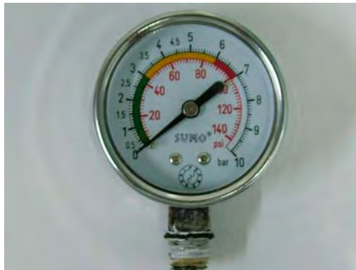
รูปที่ 3.5 เกจวัดความดัน ที่ใช้ในงานวิจัย
