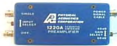
รูปที่ 2.12 อุปกรณ์ขยายสัญญาณปฐมภูมิ
