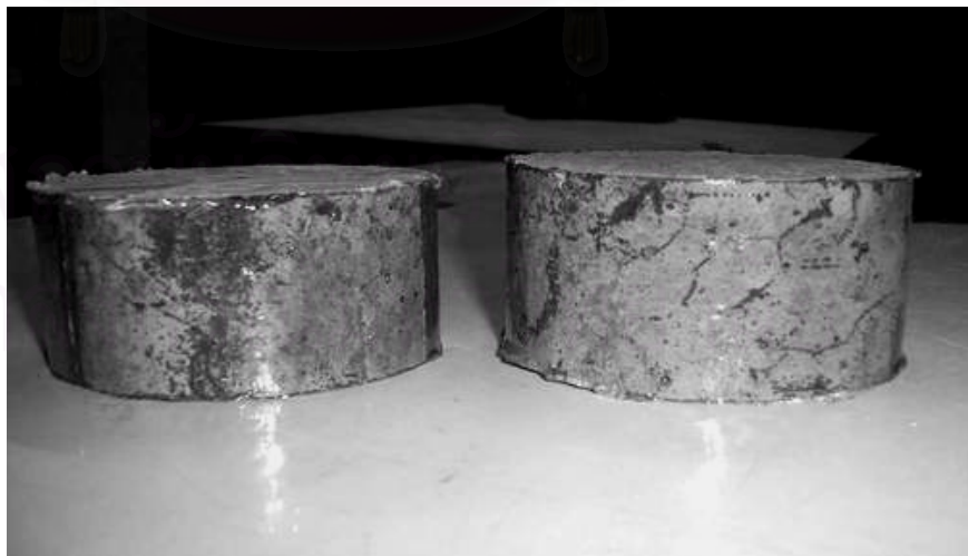
รูปที่ 3.3 ก้อนตัวอย่างที่ถูกเตรียมสำหรับการทดสอบตามมาตรฐาน ASTM C1202
