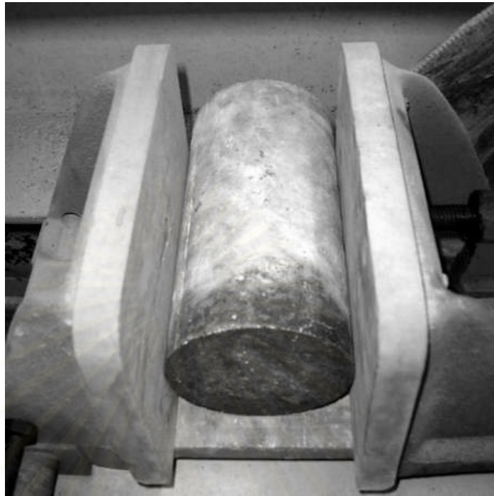
รูปที่ 3.2 การตัดก้อนตัวอย่างคอนกรีตด้วยเลื่อยหัวตัดเพชร (Diamond Saw)
