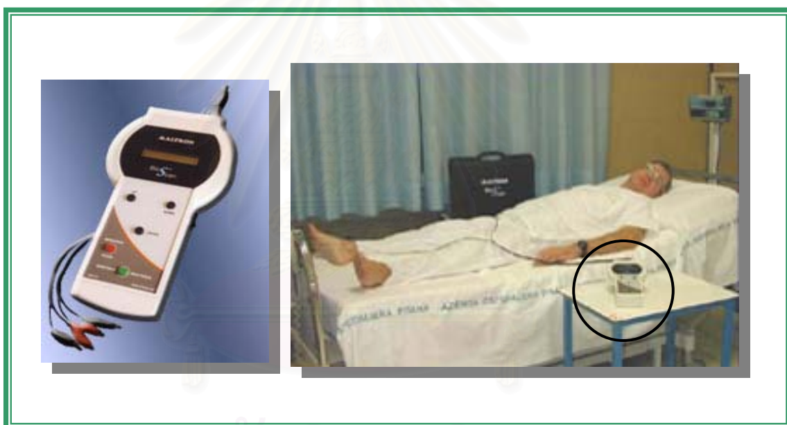
รูปที่ 10 แสดงเครื่อง Bioelectrical Impedance Analysis (BIA) Maltron® รุ่น BioScan 916 Analyser และวิธีการวัดผู้ป่วยซึ่งวัดได้ง่าย รวดเร็ว ไม่เจ็บ ไม่มีอันตราย สามารถเคลื่อนย้ายไปได้ทุกที่ ไม่ต้องอาศัยความชำนาญและการฝึกฝนมาก และราคาไม่แพง [43-44]
