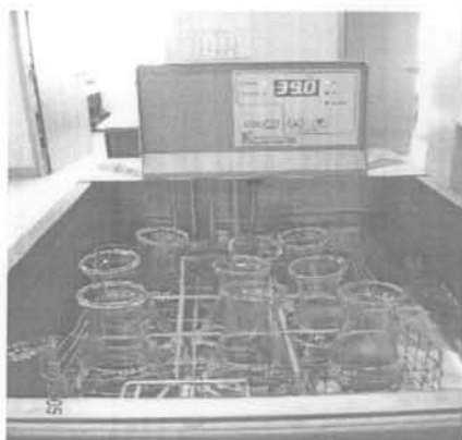
ภาพที่ 3 หลังการเติมสารละลายแล้ว ทำการบ่มที่อุณหภูมิ 39°C
