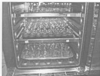
ภาพที่ 24 นำขวดเข้าบ่มที่ตู้บ่มร้อนแห้งที่ 39°C เพื่อรวัดแก๊ส
