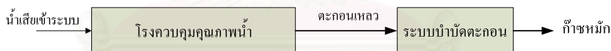
รูปที่ 3.9 ระบบบำบัดน้ำเสียขนาดใหญ่และระบบบำบัดตะกอนแยก
