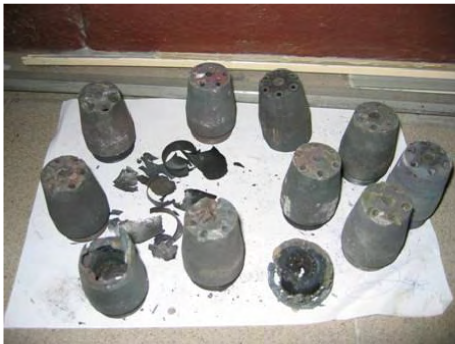
รูปที่ ก.4 ชิ้นส่วน Nozzle ที่เกิดการเสียหาย
