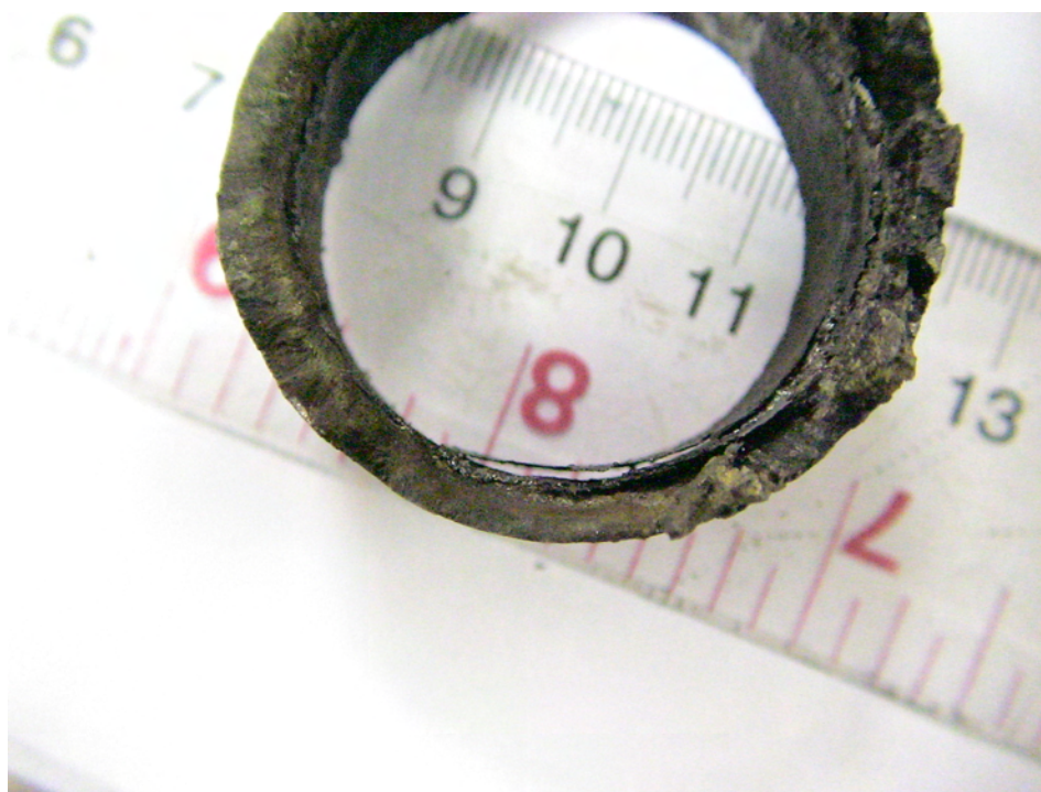
รูปที่ ก.6 ผิวหน้าด้านในของท่อเกิดการแตกตัวของชั้นสเกล (1)
