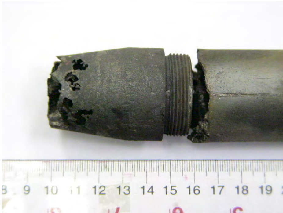
รูปที่ ก.3 บริเวณส่วนปลายท่อที่เกิดการเสื่อมสภาพ
