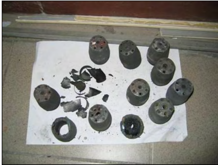
รูปที่ 4.2 แสดงหัวพ่นแก๊สที่เกิดการเสียหายและสเกลที่เกิดการหลุดร่อน
