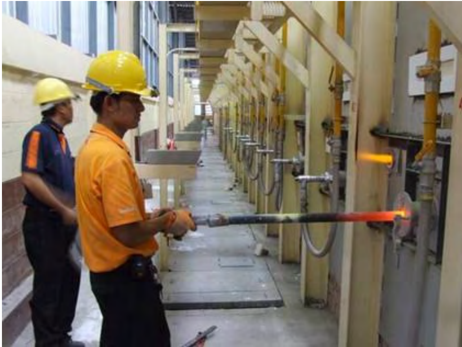
รูปที่ ก.1 เตาเผาวัสดุทนไฟและลักษณะทางกายภาพของท่อระหว่างการใช้งาน
