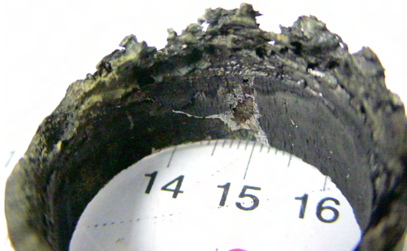
รูปที่ 4.3 ลักษณะทางกายภาพของผิวหน้าด้านในท่อบริเวณที่เกิดการเสียหายอย่างรุนแรง
