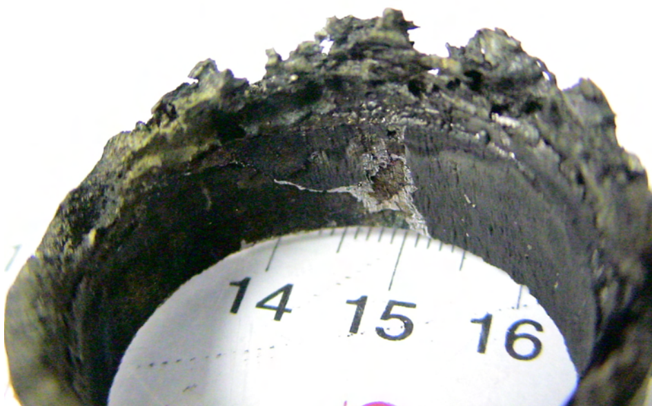
รูปที่ ก.5 ส่วนปลายของท่อที่ติดกับชิ้นส่วน Nozzle ที่เกิดการเสียหายอย่างรุนแรง
