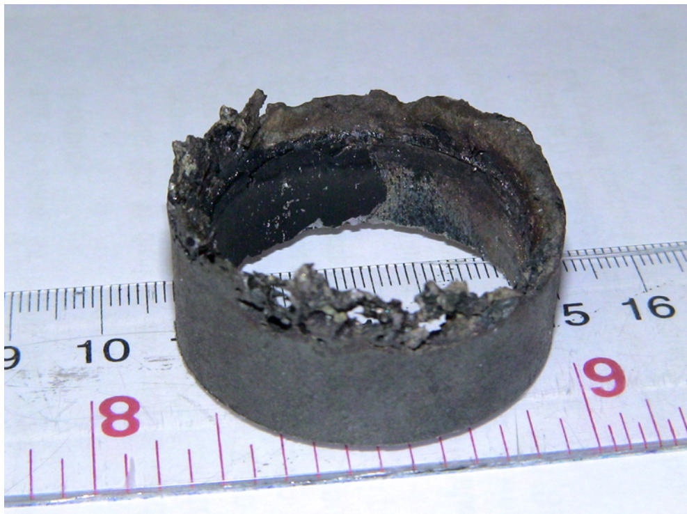
รูปที่ ก.8 การเสื่อมสภาพของส่วนปลายสุดของท่อที่ต่อกับชิ้นส่วน Nozzle
