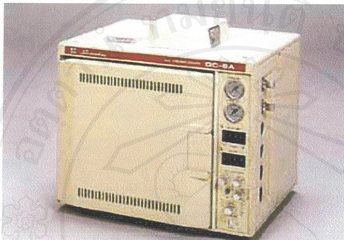
รูปที่ 3.3 เครื่องวัดองค์ประกอบก๊าซ ยี่ห้อ SHIMADZU รุ่น GC-8A
