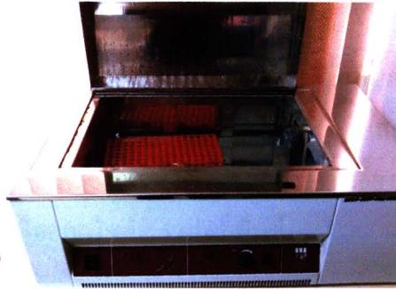
รูป 3.2 อ่างน้ำควบคุมอุณหภูมิ (Shaking water bath ยี่ห้อ GFL รุ่น 1086, Germany)
