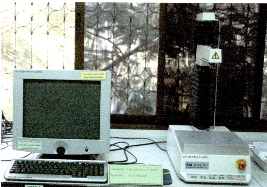
ภาพ 6 เครื่องวัดเนื้อสัมผัสอาหาร (Texture analyzer; TA-Xtplus)
