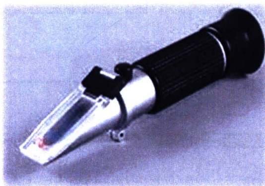
ภาพที่ 4.24 เครื่องตรวจวัดปริมาณน้ำตาล
