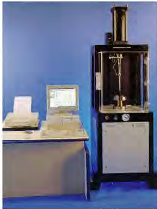
รูปที่ 3.9 เครื่อง Instrumented Impact Tester ของบริษัท Radmana Model: ITR2000
