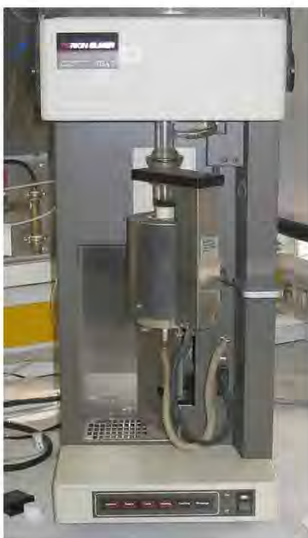
รูปที่ 3.1 เครื่อง Thermogravimetric analyzer (TGA) ของบริษัท Perkin Elmer
