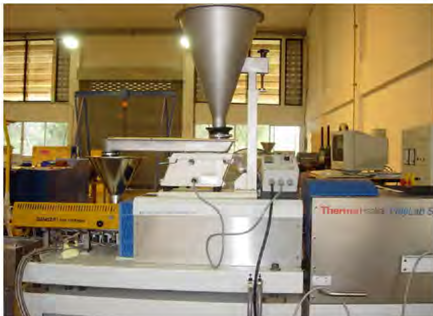
รูปที่ 3.4 เครื่องอัดรีดแบบเกลียวหนอนอกู่ (Twin screw extruder) ของบริษัท Thermo Haake
