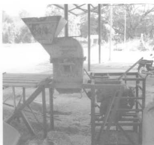
ขั้นตอนที่ 5 นำเนื้อหอยเชอรี่แห้งไปบดด้วย เครื่องบด ผ่านตะแกรงขนาด 4 มม.
