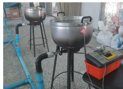
รูปที่ 8 การทดสอบศักยภาพของก๊าซเชื้อเพลิงที่ผลิตได้เมื่อนำมาประยุกต์ใช้กับเตาแก๊สชุดต้ม เพื่อผลิตพลังงานความร้อน
