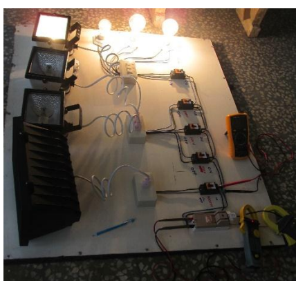
รูปที่ 10 อุปกรณ์ไฟฟ้าที่มีกำลังไฟฟ้าขนาดต่าง ๆ ที่ใช้ในการทดสอบกระแสไฟฟ้าที่ผลิตได้จากเครื่องกำเนิดไฟฟ้าที่ใช้ก๊าซเชื้อเพลิงเป็นแหล่งเชื้อเพลิง
