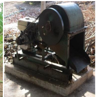
รูปที่ 2 เครื่องตัดบดหยาบ
