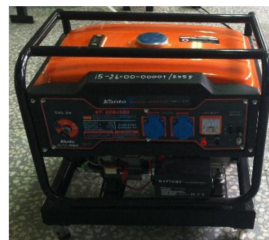
รูปที่ 9 เครื่องกำเนิดไฟฟ้าที่มีการดัดแปลงให้สามารถใช้เชื้อเพลิงได้ทั้งน้ำมันเบนซิน 91 และก๊าซเชื้อเพลิง
