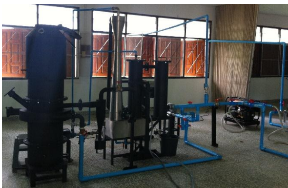
รูปที่ 7 เครื่องผลิตก๊าซเชื้อเพลิงจากชีวมวลแบบไหลลงรุ่นสุดท้าย
