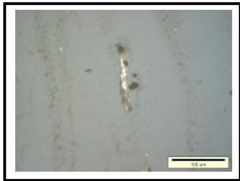
ภาพที่ 4-1 อนุภาคการสึกหรอจากเครื่องทดสอบแบบพินอินดิคส์ ใช้เวลา 15 นาที
