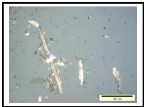
ภาพที่ 4-1 อนุภาคการสึกหรอจากเครื่องทดสอบแบบพินอินดิคส์ ใช้เวลา 15 นาที
