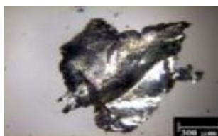
ภาพที่ 2-35 อนุภาคการสึกหรอจากการล้าตัวแบบเป็นก้อน
