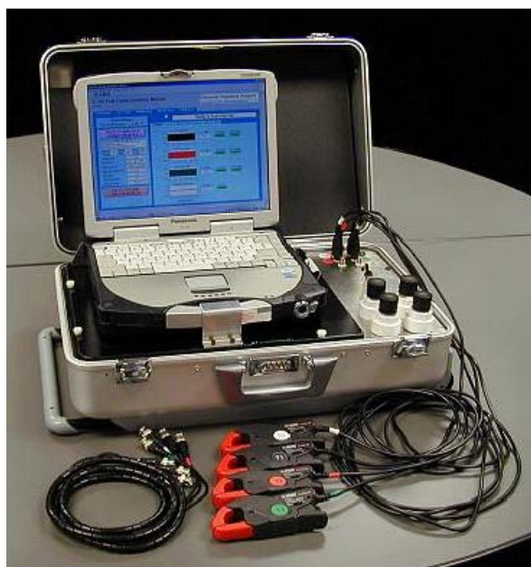
ภาพที่ 2-5 อุปกรณ์วัดกระแสไฟฟ้าของมอเตอร์
