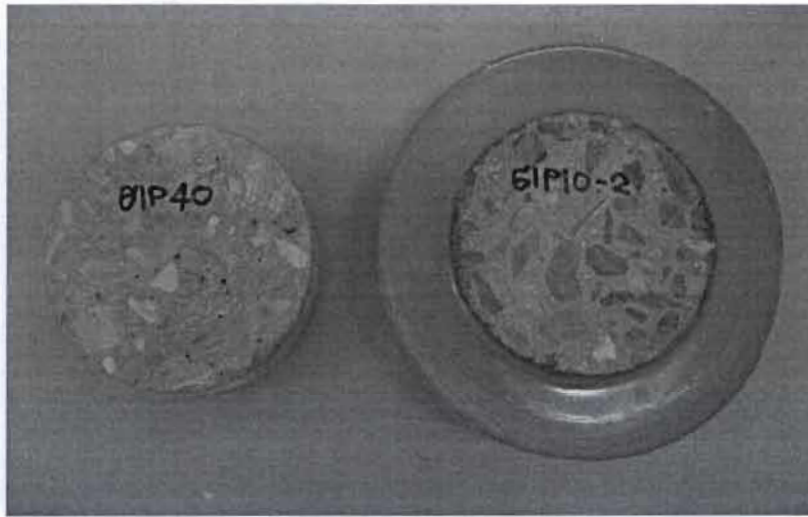
รูปที่ 3.3 ตัวอย่างคอนกรีตที่หล่อ Epoxy
