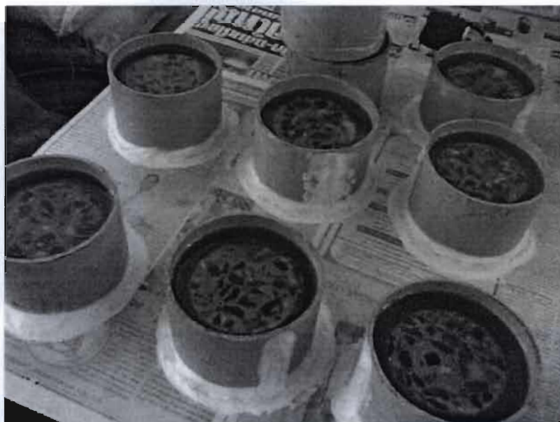
รูปที่ 3.1 แบบหล่อตัวอย่างคอนกรีตด้วยอีพอกซี (Eproxy)
