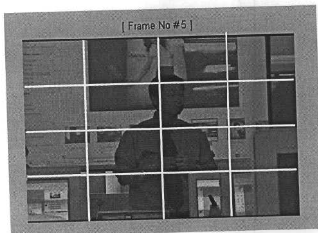
ภาพที่ 3-4 ลักษณะการแบ่งภาพเพื่อใช้วิเคราะห์แบบเป็นบล็อก
