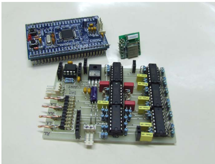
ภาพที่ 3-3 ส่วนประกอบของเครื่องตรวจวัดสัญญาณคลื่นไฟฟ้าหัวใจ
