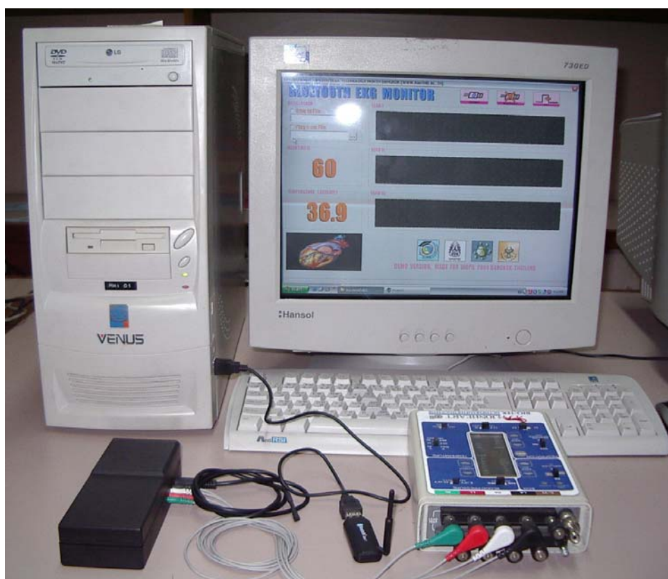
ภาพที่ 3-6 ลักษณะการเชื่อมต่อของเครื่องตรวจวัดคลื่นไฟฟ้าหัวใจและอุปกรณ์ที่ใช้ร่วมในการวิจัย
