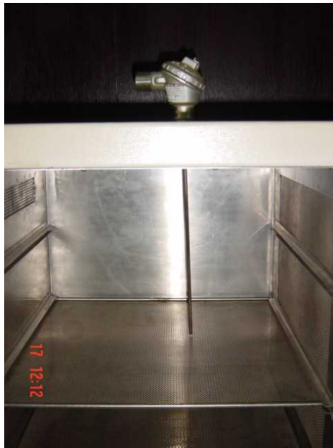
ภาพที่ 1.30 การติดตั้งใช้งานในลักษณะต่างๆ ของเซนเซอร์ ตรวจวัดอุณหภูมิแบบ อาร์ทีดี (RTD)
