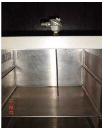
ภาพที่ 1.24 การติดตั้งใช้งานในลักษณะต่างๆ ของเซนเซอร์ ตรวจวัดอุณหภูมิแบบ อาร์ทีดี (RTD)
