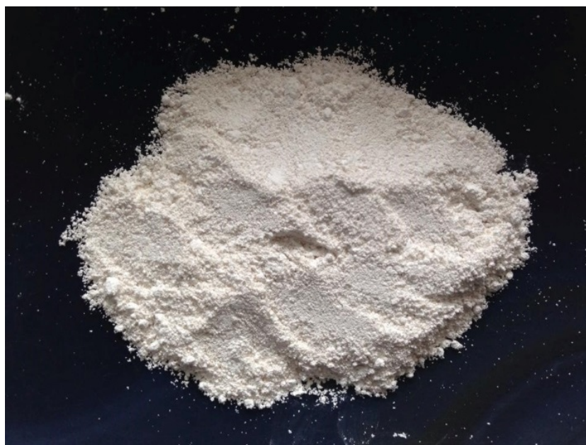
ภาพที่ 4.2 ผงแคลเซียมคาร์บอเนตที่เตรียมจากเปลือกไข่
