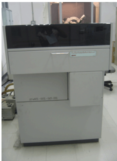
ภาพที่ 3.2 เครื่องเอกซเรย์ฟลูออเรสเซนซ์สเปกโตรมิเตอร์ (X-ray Fluorescence Spectrometer) รุ่น SRS 3400
