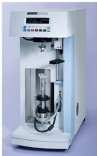
ภาพที่ 3.3 เครื่องเทอร์โมกราวิเมตริกอนาไลเซอร์ (Thermogravimetric Analyzer) รุ่น Pyris 1
