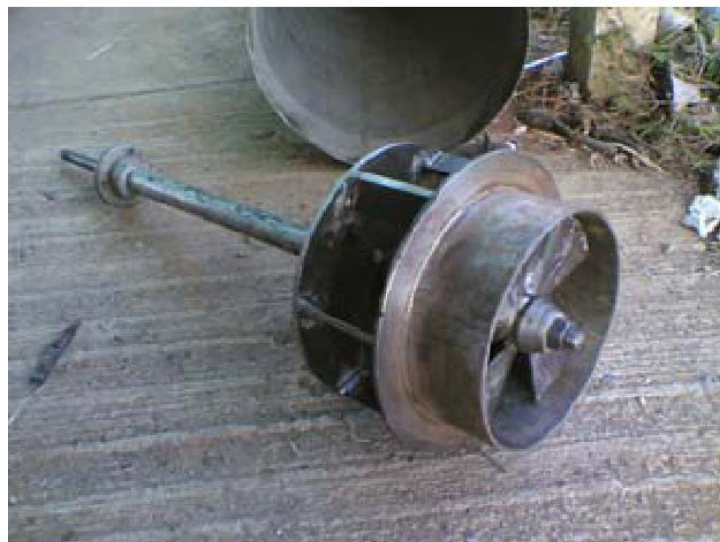
รูปที่ 2.24 ใบกังหันน้ำที่นำมาใช้ ขนาดเส้นผ่านศูนย์กลาง 0.20 m [31]
