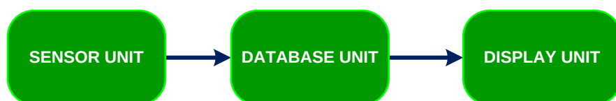
รูปที่ 1.1 โครงสร้างระบบวัดและแสดงผลพลังงานจากแสงอาทิตย์และพลังงานจากลม
