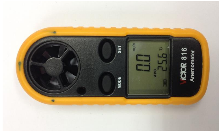
รูปที่ 4.11 เครื่องมือทดสอบความเร็วลม VICTOR 816 Digital Anemometer
