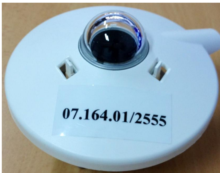
รูปที่ 3.7 แสดงเครื่องวัดความเข้มรังสีดวงอาทิตย์ Kipp & Zonen's CMP3
