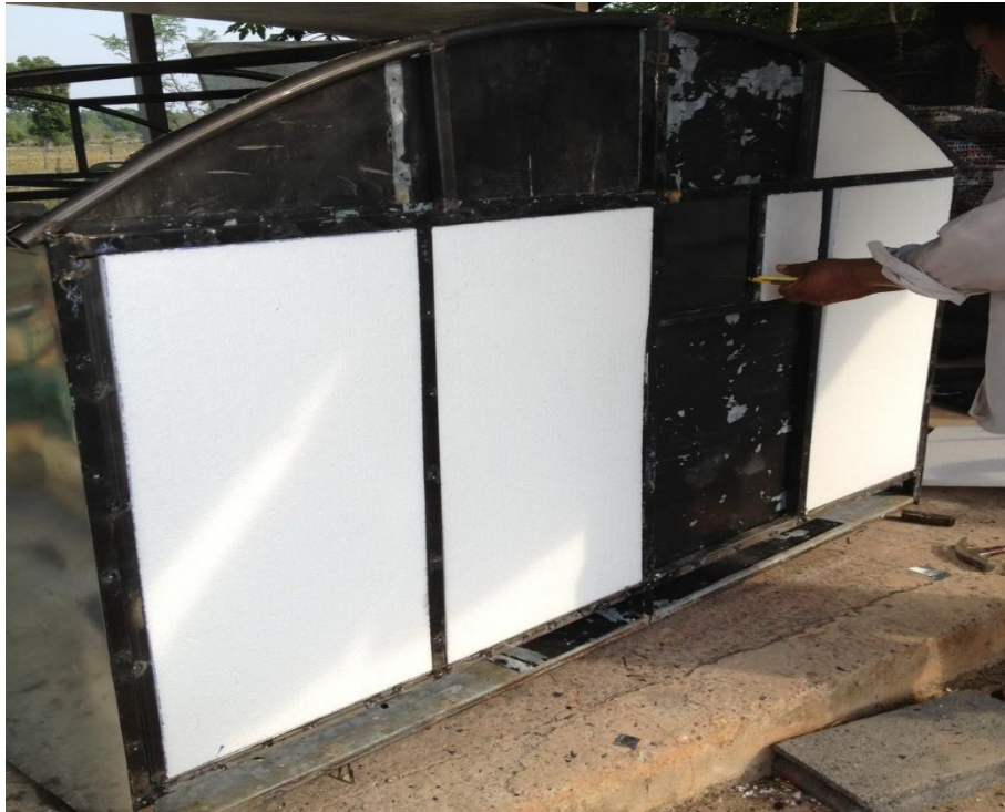
รูปที่ 3. 3 แสดงฉนวนที่ใช้บุเครื่องอบแห้ง
