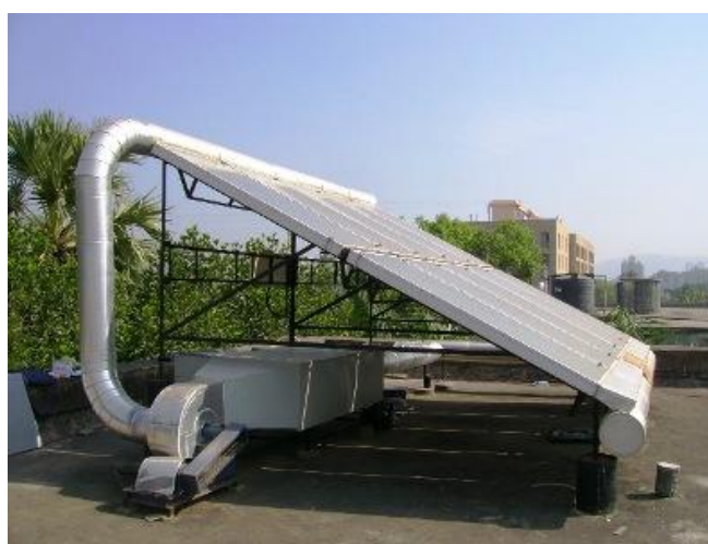
รูปที่ 2.10 แสดงเครื่องอบแห้งแบบรับพลังงานแสงอาทิตย์ทางอ้อมและใช้พัดดูดอากาศ(ทนงศักดิ์ วัฒนา 2011)
