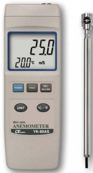
รูปที่ 3.5 เครื่องวัดความเร็วลม ยี่ห้อ Lutron รุ่น YK-80AS
