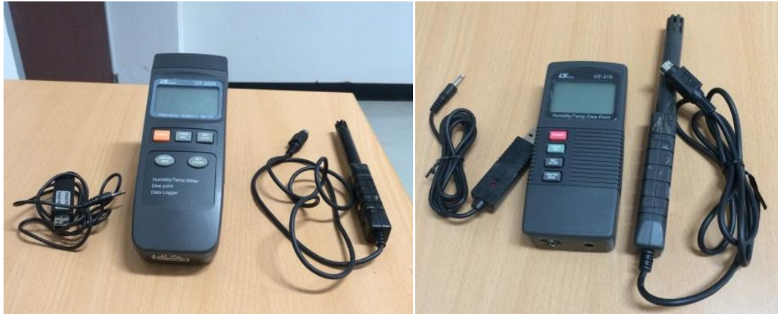
รูปที่ 3. 10 แสดงเครื่องวัดความชื้นสัมพัทธ์ ยี่ห้อ Lutron รุ่น HT-3009 และเครื่องวัดความชื้นสัมพัทธ์ ยี่ห้อ Lutron รุ่น HT-3007SD
