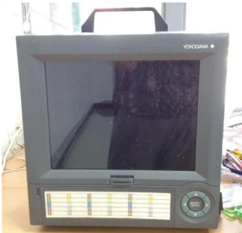
รูปที่ 3. 9 แสดง Data Recorder ยี่ห้อ YOKOGAW รุ่น DX 200
