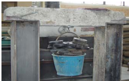
(ค) แสดงการให้น้ำหนักถ่วง 5 kg/ min
