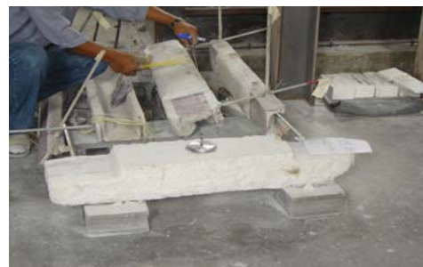
(ข) การติดตั้งเครื่องมือกับชิ้นงาน
