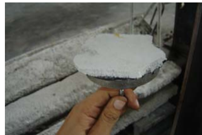
(ง) แสดงวัสดุป้องกันไฟหลังการทดสอบ
