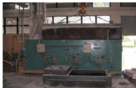
(ข) แสดงเตาเผาที่ใส่ตัวอย่างทดสอบแล้ว
