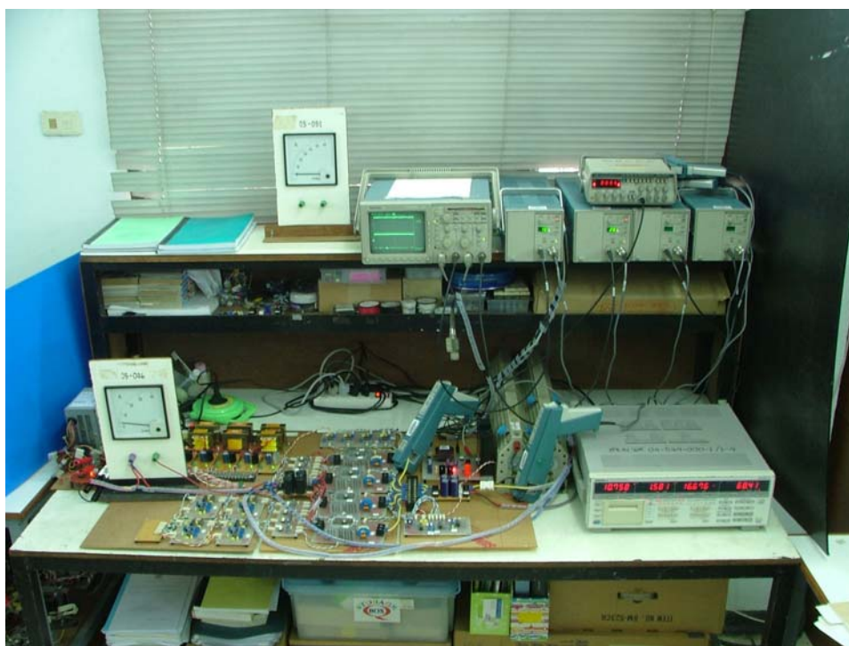
ภาพที่ ข-4 การทดสอบวงจรแปลงผันไฟตรง-ไฟตรงแบบที่สร้างขึ้นทั้งระบบ
