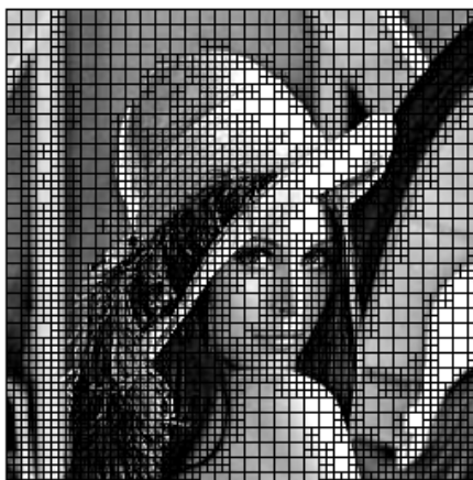
ภาพที่ 3-4 การแบ่งภาพ Lena.bmp ขนาด 256x256 แบบแบ่งสี่ส่วน (Quadtree)
