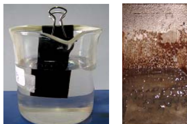
ภาพที่ 4-6 การทดสอบการบวมตัวในน้ำของวัสดุผสมสำหรับเคลือบผิวเหล็ก ที่มีส่วนประกอบของดินขาว 2.00 กรัม, แป้งมัน 3.00 กรัม, โพลีอะครายลาไมด์ 0.00 กรัม(0.00 %)
