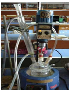
ภาพที่ 3-1 แสดงชุดทดลองในการกราฟท์ดินขาว-แป้งมันกับอะครายลาไมด์
