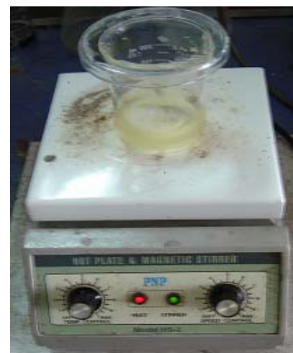
ภาพที่ 3-1 แสดงชุดทดลองในการกราฟท์ดินขาว-แป้งมันกับอะครายลาไมด์
