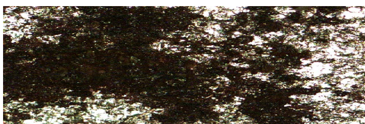
ภาพที่4-43 แสดงภาพพื้นผิวของเหล็กแผ่นชิ้นที่ 1. ที่ไม่มีการเคลือบ แล้วทิ้งไว้ที่ความชื้น 85 % เป็นเวลา 50 วัน (กำลังขยาย 50 เท่า)
