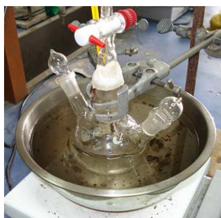
ภาพที่ 3-2 แสดงขั้นตอนการสังเคราะห์โพลีอะครายลาไมด์
