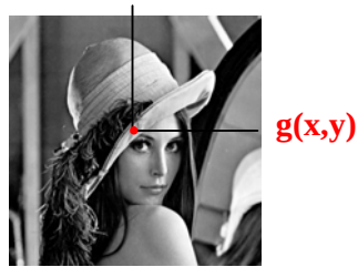
ภาพที่ 2-1 ภาพในความหมายของฟังก์ชัน 2 มิติ g(x,y) ของค่าความเข้มแสง ณ ตำแหน่ง (x,y)
