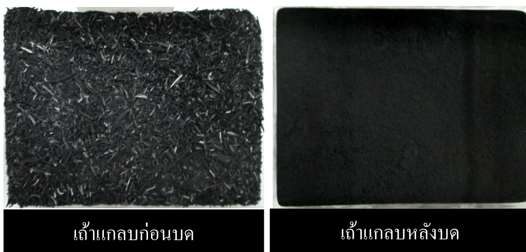
รูปที่ 4.1 แสดงลักษณะทั่วไปและสีของเถ้าแกลบก่อนและหลังการบด
