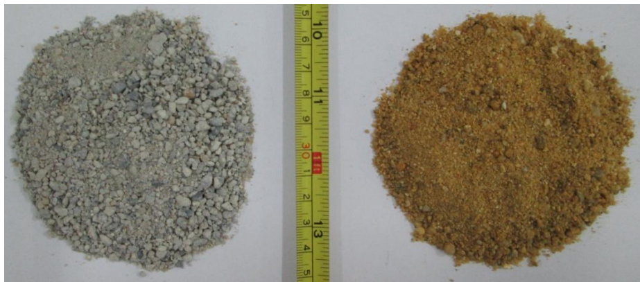
รูปที่ 4.2 มวลรวมละเอียดที่ได้จากการย่อยเศษคอนกรีตและทรายธรรมชาติ
