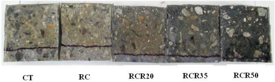
รูปที่ 4.11 ระยะการแทรกซึมคลอไรด์ของคอนกรีตที่ใช้มวลรวมหยาบที่ได้จากการย่อยเศษคอนกรีต และทรายธรรมชาติร่วมกับเถ้าแกลบบดละเอียดที่อายุ 90 วัน
