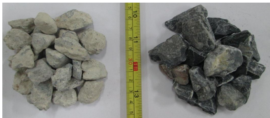
รูปที่ 4.3 มวลรวมหยาบที่ได้จากการย่อยเศษคอนกรีตและหินปูนย่อย
