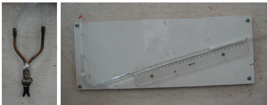
ภาพที่ 3-10 ปิตอร์ทูปแบบ-S และมาโนมิเตอร์แบบท่อเอียง
