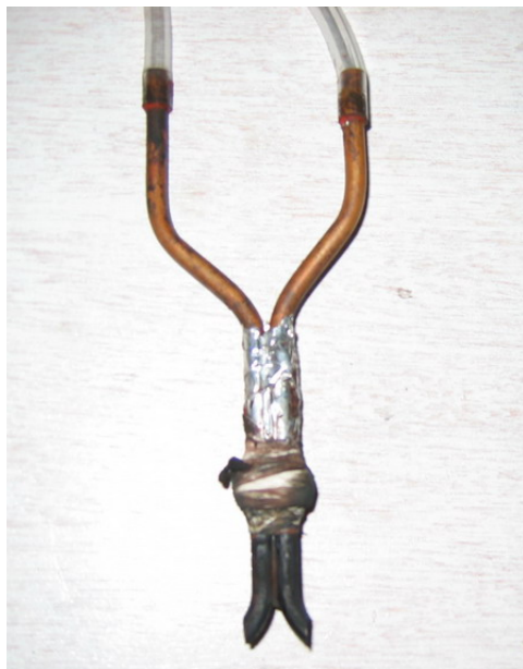
ภาพที่ ก-5 ปิเตอร์ทูปแบบ-S วัดอัตราการไหลก๊าซผลิตภัณฑ์ที่ทางออก
