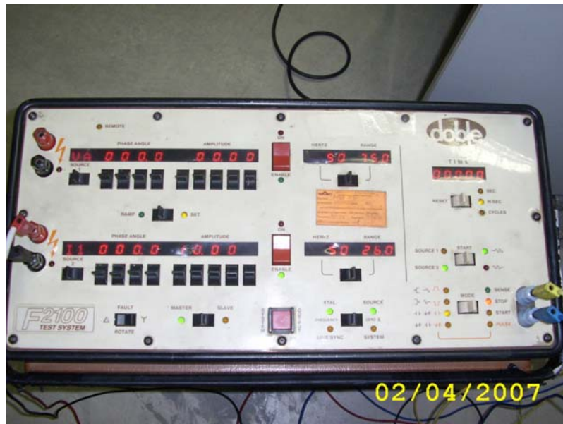
ภาพที่ 4-3 เครื่องทดสอบรีเลย์ DOBLE F2100
