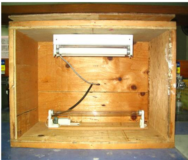
ภาพที่ 3-8 ชุดทดลองการได้รับแสงในช่วงยูวีและวิสิเบิลที่สร้างขึ้น
