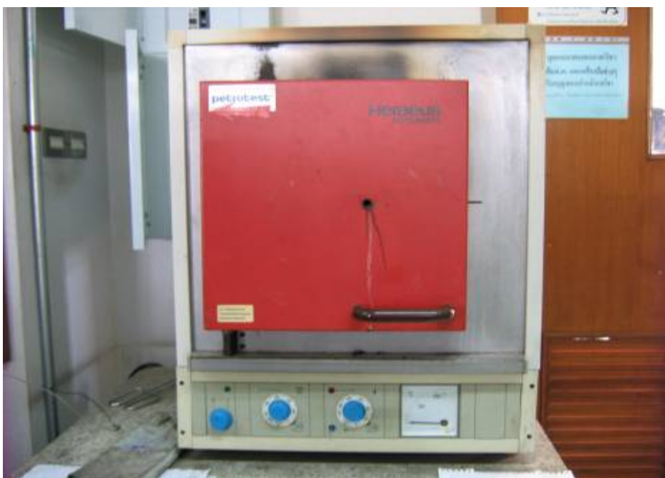
ภาพที่ 3-2 เตาเผาสำหรับเตรียม S-doped \text{TiO}_2 (furnace, T_{\text{max}} = 1200\text{ }^{\circ}\text{C} )
