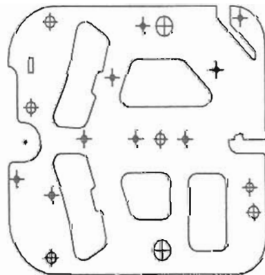
ภาพที่ 2-15 แผ่นชิ้นส่วนของนาฬิกาปลุก มาตรฐาน 1 : 1 วัสดุ Cu Zn 36
