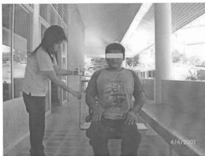
ภาพที่ ข-3 แสดงการวัดความสูงไหล่ขณะนั่ง (Acromion height, sitting)
