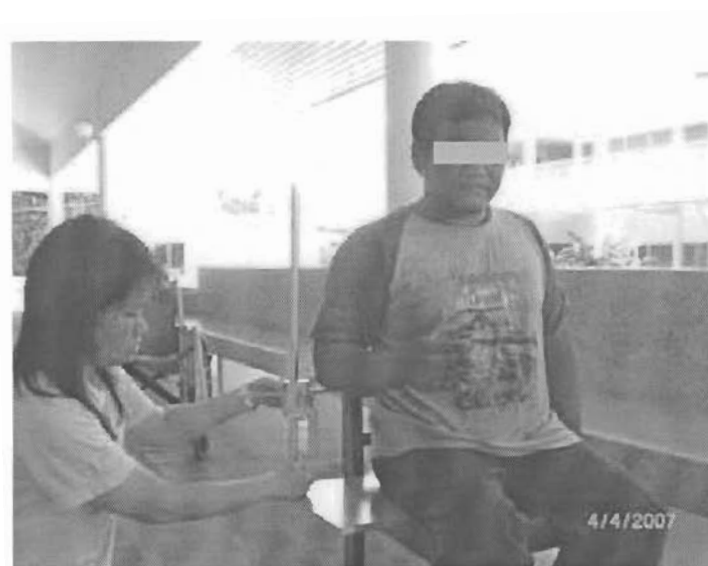
ภาพที่ ข-4 แสดงการวัดความสูงจากระดับที่นั่งถึงข้อพับศอก (Elbow rest height, sitting)
