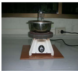
รูปที่ 10 ลักษณะการให้ความร้อนวัตภาคน้ำมันและน้ำด้วยการใช้อ่างน้ำร้อน
