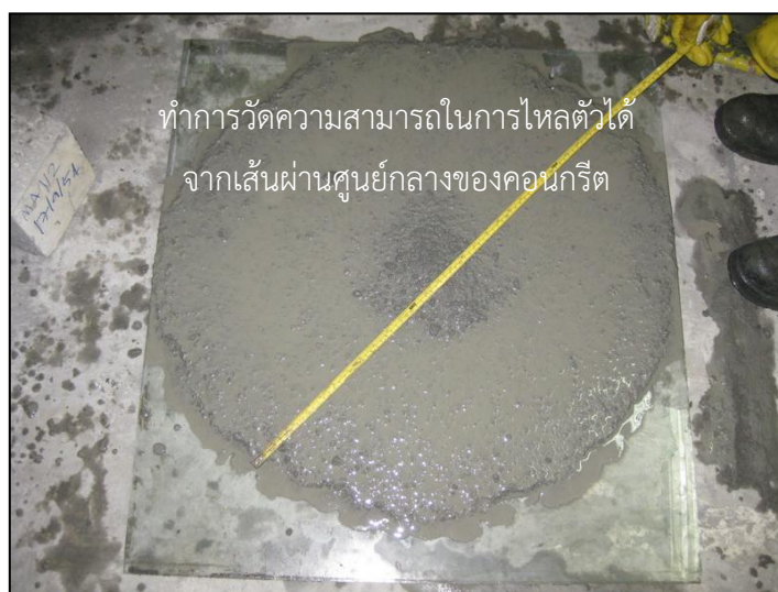
รูปที่ 4.5 อุปกรณ์ทดสอบความสามารถในการไหลตัวได้โดยใช้กรวย Abram
