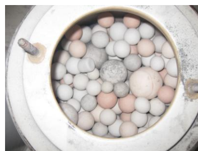
รูปที่ 4.3 เครื่องบดเถ้าแกลบแบบ Ceramic Ball Mill ที่สาขาวิชาเซรามิกส์
