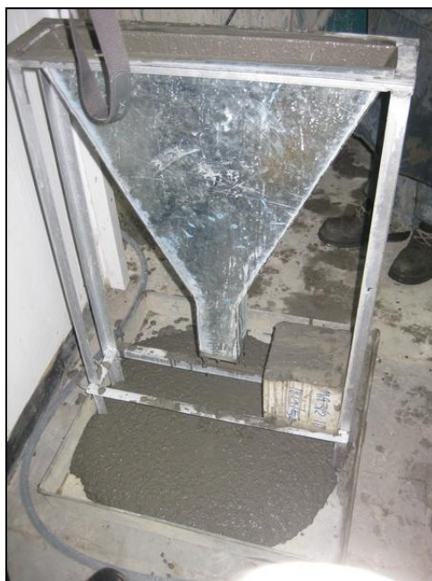
รูปที่ 4.6 อุปกรณ์ทดสอบความสามารถในการไหลโดยใช้ V-funnel
