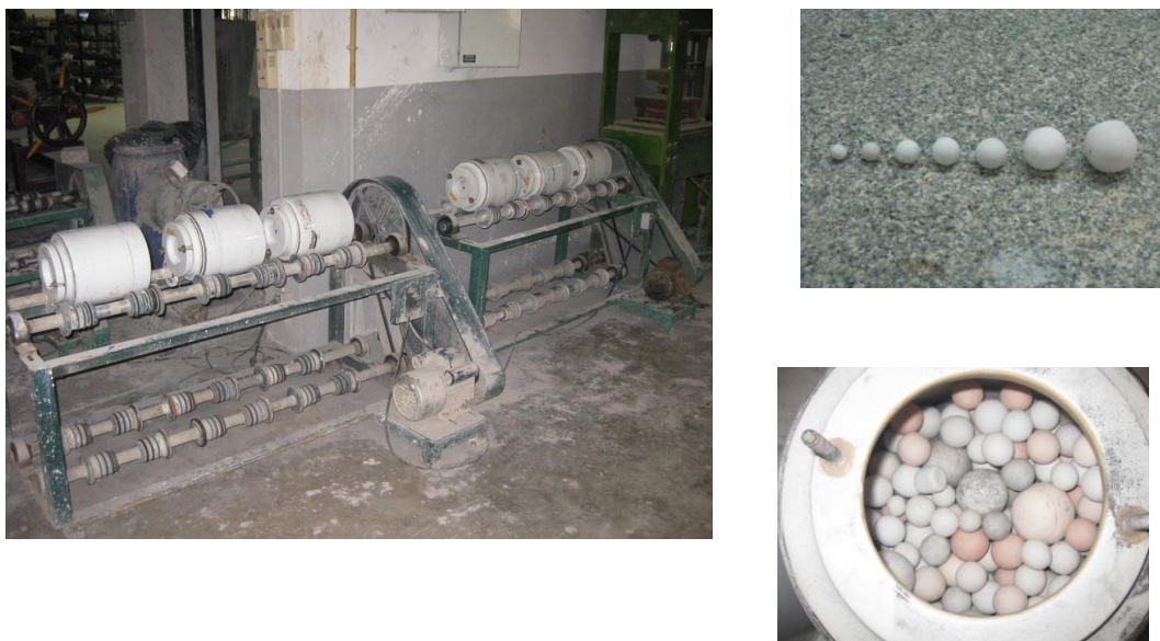
รูปที่ 3.1 เครื่องบดกลบแบบ Ceramic Ball Mill ที่สาขาวิชาเซรามิกส์
