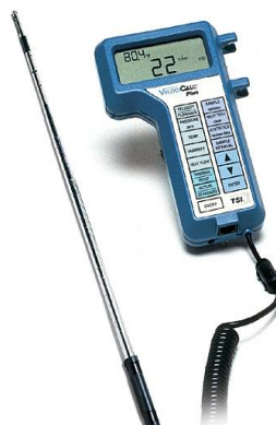
รูปที่ 3.2 Multi-Parameter ventilation meter [18]
