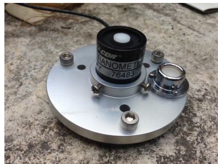
รูปที่ 3.5 เครื่องวัดปริมาณรังสีอาทิตย์ (Pyranometer)
