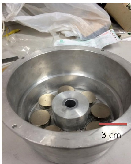
รูปที่ 3.14 การวางแม่เหล็กของล้อแบบที่ 5
