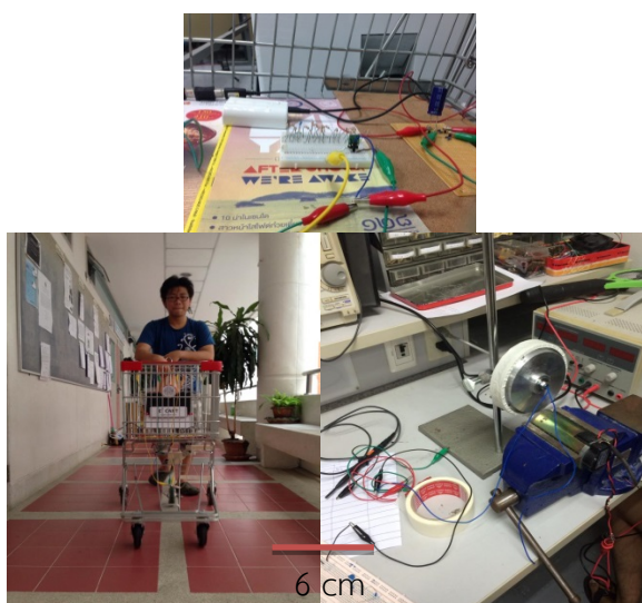
รูปที่ 4.41 ทดลองใช้มอเตอร์ในการปั่นล้อ และการเซ็นรตเซ็นช้อปป์จากการใช้งานจริงประจุพลังงานใส่แบตเตอรี่ผ่านวงจรจัดการพลังงาน
