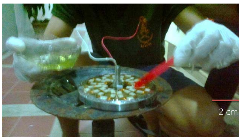
รูปที่ 3.35 การหล่อเรซินของขดลวดล้อยตันแบบที่ 1 ถึงล้อยตันแบบที่ 4
