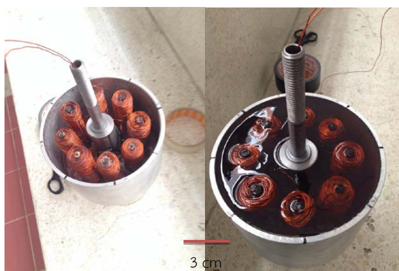
รูปที่ 3.36 การหล่อเรซินของขดลวดล้อยตันแบบที่ 5 และล้อยตันแบบที่ 6
