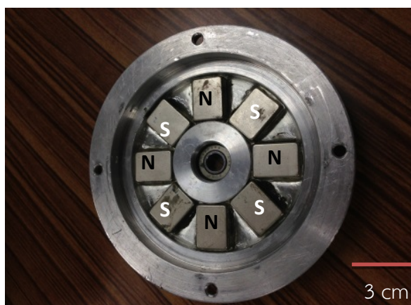
รูปที่ 3.3 ลักษณะการวางแม่เหล็กของล้อต้นแบบที่ 1
