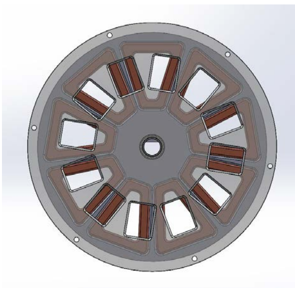
รูปที่ 3.31 ตำแหน่งของแม่เหล็กเมื่อเทียบกับขดลวดของล้อต้นแบบที่ 7
