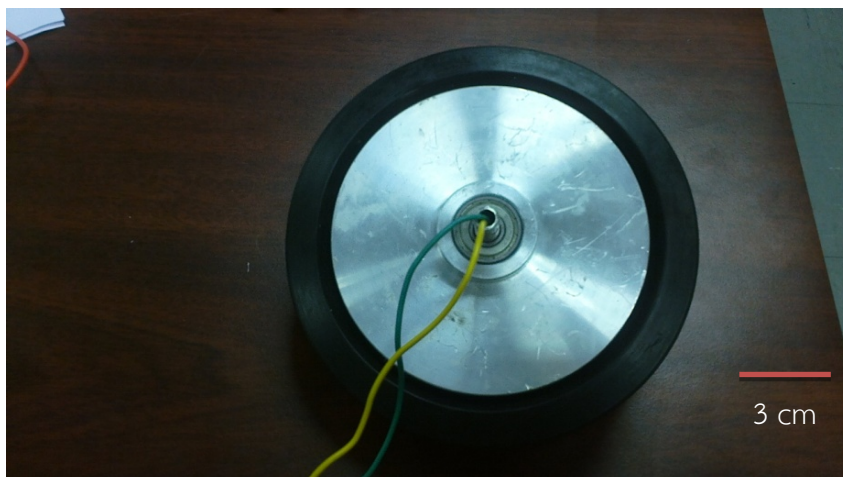
รูปที่ 3.41 การประกอบฝาครอบกับชุดขดลวดตัวนำ
