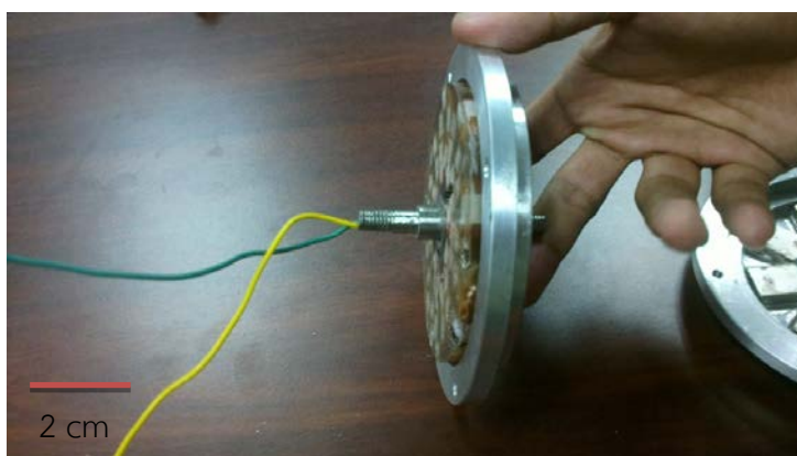
รูปที่ 3.40 การประกอบฝาครอบกับชุดขดลวดตัวนำ
