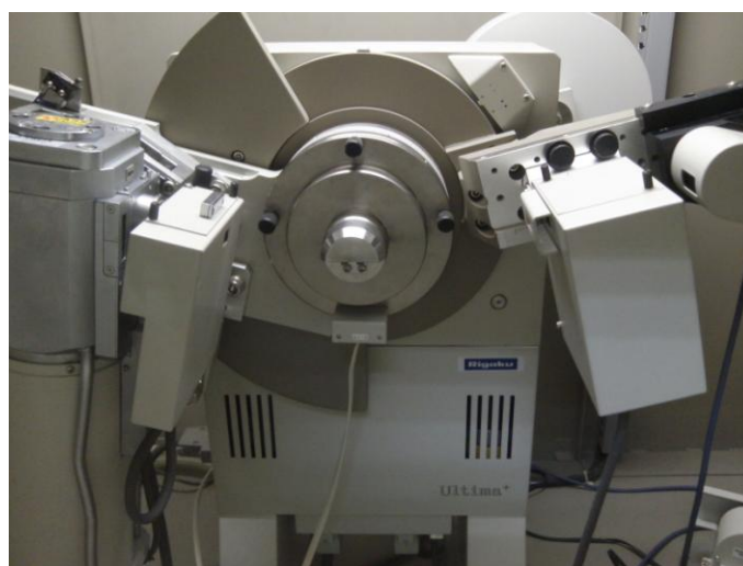
รูปที่ ค-6 แสดงส่วนประกอบภายในของเครื่อง XRD ที่ใช้ในการทดลองนี้
