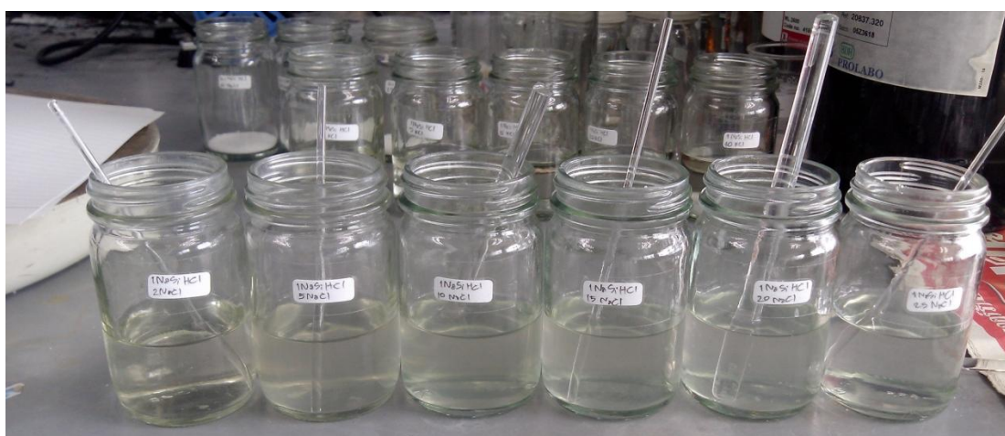
ภาพที่ 3.8 ตัวอย่างสารละลายโซเดียมซิลิเกตที่ส่วนผสมและความเข้มข้นต่างๆที่เตรียม
