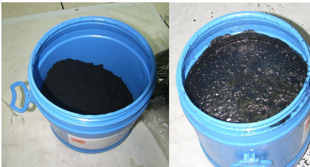
ภาพที่ 3.3 เถ้าแกลบก่อนล้างน้ำและเถ้าแกลบขณะแช่สารละลายกรดไฮโดรคลอริก
